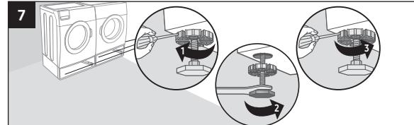
Using a level, make sure the units are level side to side and front to back. Do additional leveling as needed. Proper leveling keeps vibration at a minimum. Con un nivel, compruebe si las unidades están niveladas de lado a lado y de adelante atrás. Realice la nivelación adicional necesaria. Una nivelación correcta reduce la vibración al mínimo.
