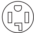
Tomacorriente de 4 hilos (14-30R)
