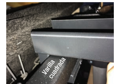
Soporte "enganchado" en la varilla cuadrada
