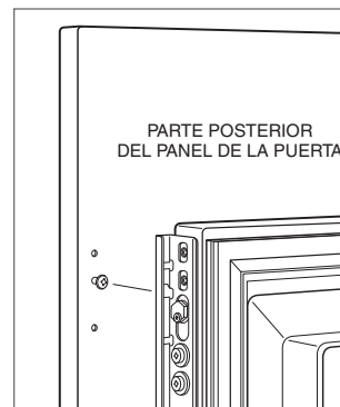
Montaje del panel de la puerta
