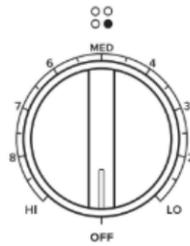
Les boutons de commande peuvent être réglés à n'importe quelle position entre HI (élevée) et LO (basse). Pousser et tourner le bouton au réglage.
